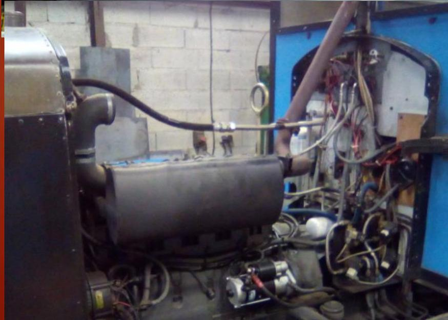
Flexible air comprimé neuf et échappement remonté
